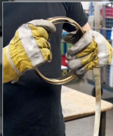
Glänzendes Band: Edelmetallbänder sind ein typisches Halbzeug der Schmuckindustrie. Ein Gasgemisch schützt das Edelmetall beim Glühvorgang vor Oxidation.
