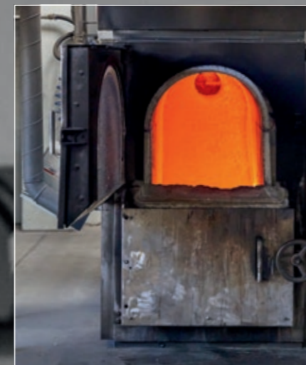
Heiß gereinigt: Mit der Veraschung beginnt das Recycling der Edelmetalle.
