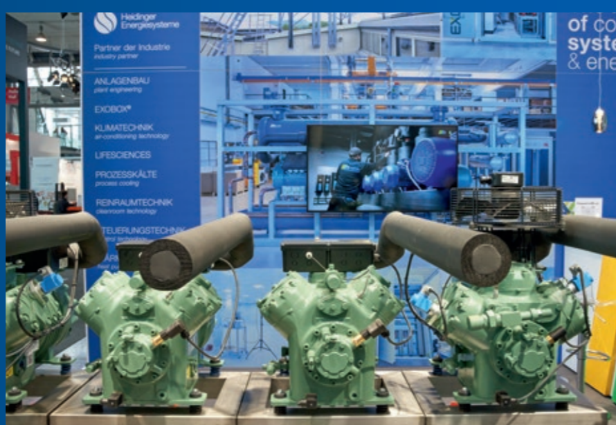
Zu Gast auf dem Heidinger Messestand: Wärmepumpe mit drehzahlregelbarem Hubkolbenverdichter.
